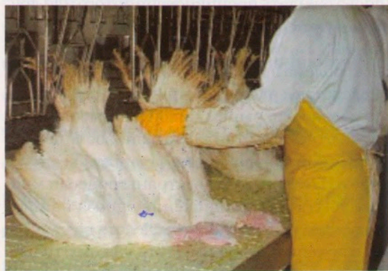
Рис. 2. Наилучшее решение для подачи индейки на линию убоя: оператор просто помещает ноги оглушенной птицы в петли линии навески
