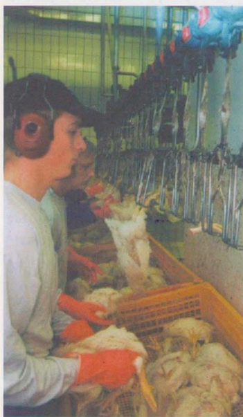
Рис. 1. Навеска обездвиженной птицы ускоряет процесс, облегчает работу оператора и снижает травматизм
