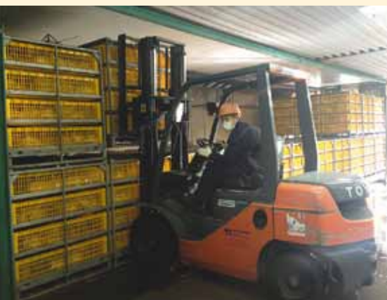
■ Разгрузка модулей с живой птицей, пришедших с фермы, в приемном отделении вилочным погрузчиком
