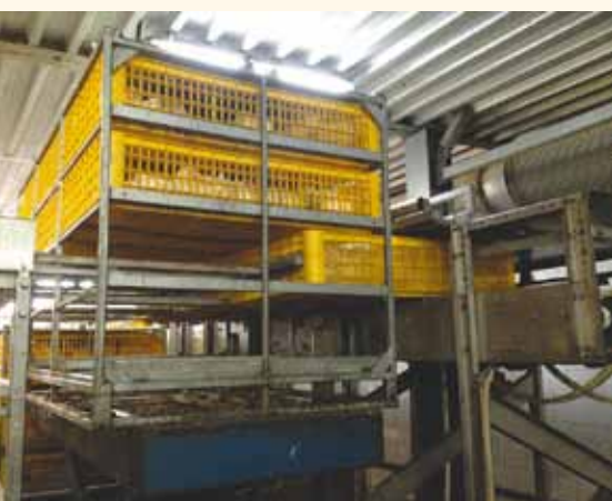
■ Автоматическая выгрузка ящиков без крышек с живой птицей на конвейер приемного отделения
