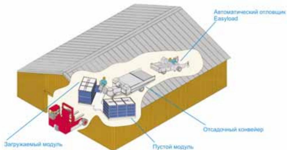
АВТОМАТИЧЕСКАЯ система отлова и загрузки птицы
